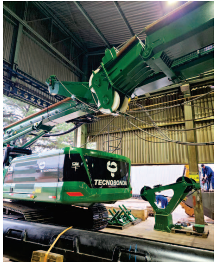
Torre c/ cabeça de CFA c/ dobra hidráulica
