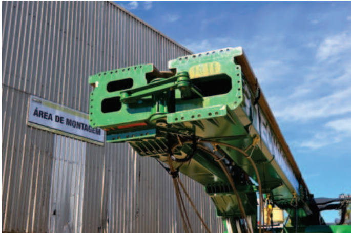
Dobra hidráulica da torre
