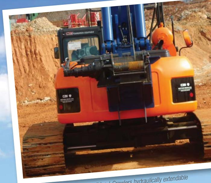
Esteiras hidraulicamente estendidas / Crawlers hydraulically extendable
